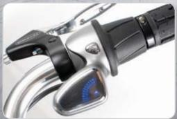
Auswahl des Schaltmodus': Automatisch, um die Trittfrequenz einzuhalten, Manuell, um das Übersetzungsverhältnis einzuhalten
