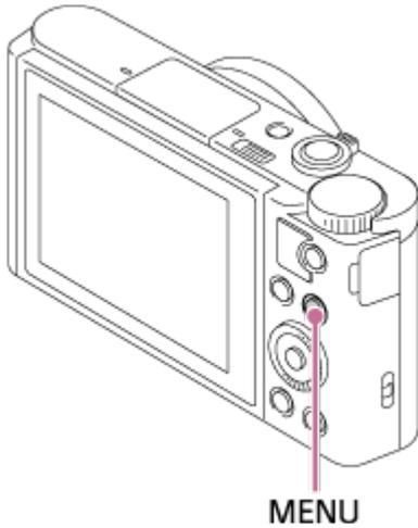
2. Wählen Sie den gewünschten MENU-Posten durch Drücken der oberen/unteren/linken/rechten Position des Einstellrads oder durch Drehen des Einstellrads aus, und drücken Sie dann ● in der Mitte des Einstellrads.
